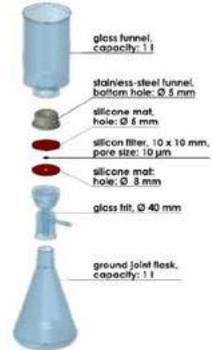
Abb. 2 Apparatur zur Überführung von Flüssigproben auf Siliziumfilter
