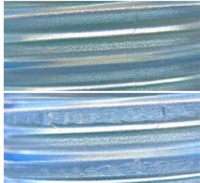
Abb. 1 Unbeschädigtes Flaschengewinde (oben), beschädigtes Flaschengewinde (unten)
