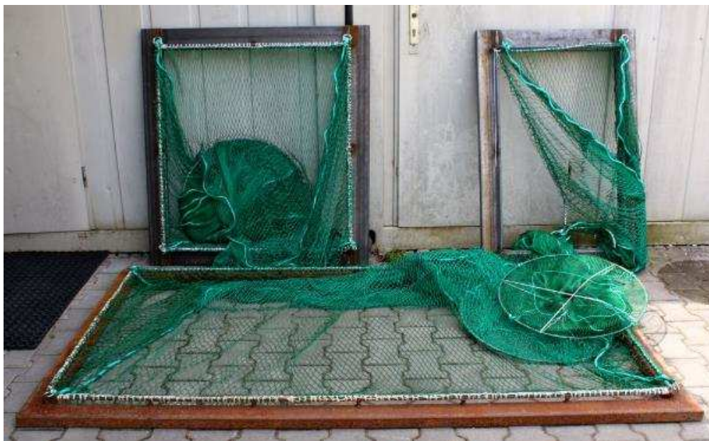
Abbildung 5 Stahlrahmen mit angeschlagenem Hamennetz; 50% Hamen (links stehend), 30% Hamen (rechts stehend) und 100% Hamen am Standort Moosach/Freising.
