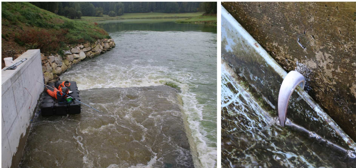
Abbildung 10 Links: Strömungsmessungen während der Grundpassage. Rechts: Bei der Grundpassage zwischen Kraftwerksgehäuse und Betonwand eingeklemmter Aal.
