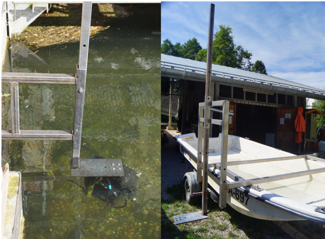
Abbildung 39 Links: Stationäres Modul mit Halter und Befestigungsarm; Rechts: Mobiles Modul I befestigt auf einem Carolina Skiff J14.
