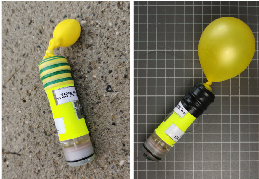
Abbildung 37 Am Sensorfisch angebrachter Auftriebskörper (gelb) unmittelbar vor dem Einsatz (links) und vollständig gefüllt nach der Bergung (rechts).
