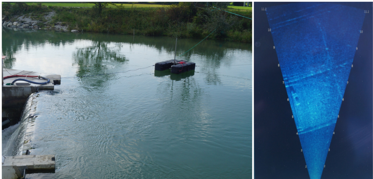
Abbildung 10 Mobiler Schwimmponton mit montiertem Sonar im Oberwasser des Kraftwerks (links) und Sonarbild der orografisch rechten Rechenebene (rechts).
