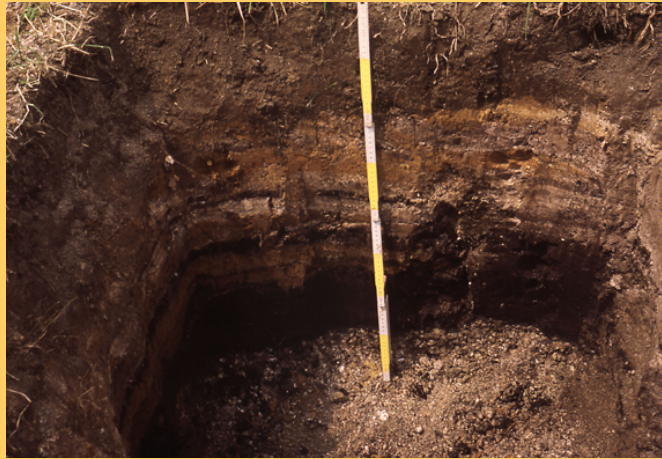
(Foto 3: Schichtenfolge von Ocker (gelbbraun) und Alm (weiß) in Niedermoor (dunkel) über Kies (unten) Gut Grünschwaige, östl. Eittingermoos, Lkr. FS; Aufn.: H.H.Becher, 22.06.1989)
