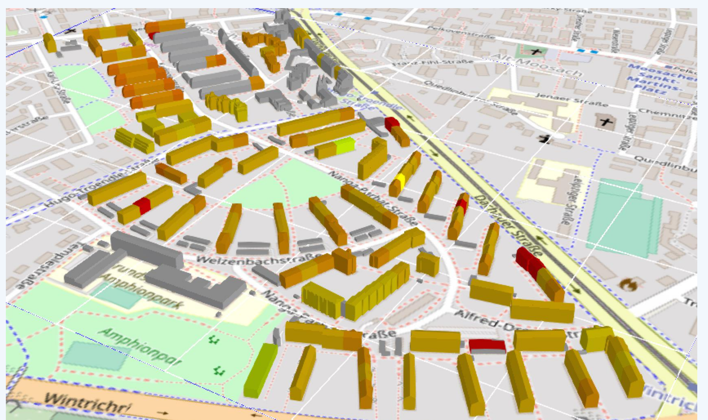
Abbildung 4: Visualisierter gebäudespezifischer Energieverbrauch im Ausgangszustand, Vorbereitung eines Wettbewerbs im Untersuchungsgebiet Moosach, Stadtsanierung der Landeshauptstadt München, Quelle: 3DCityDB-WebMapClient [6]
