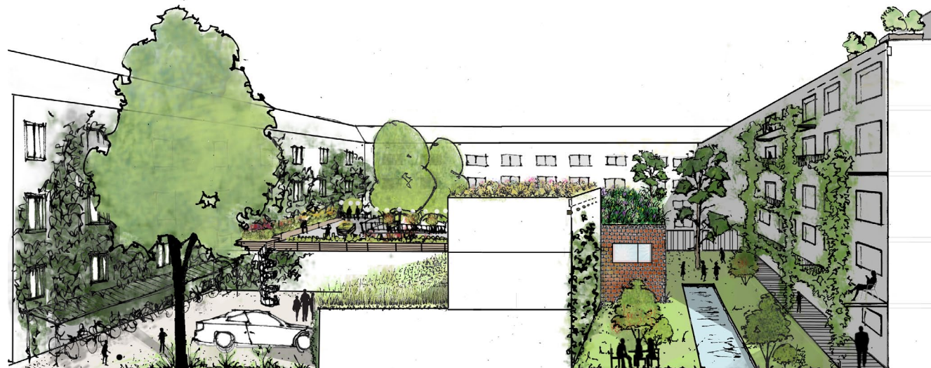
Abbildung 40: Schnitt-Perspektive durch einen Hof der Blockbebauung mit begrünten Fassaden, als Biotop oder Garten genutzten Dächern und begrünten Hinterhöfen mit Hofbäumen und offenen Wasserstellen
